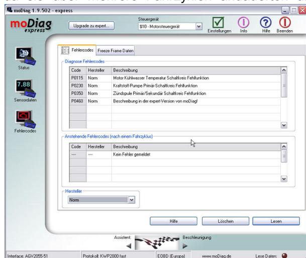
somit einen dauerhaften Fehler darstellen. Die anstehenden Fehler sind diejenigen, welche nur bei einem Fahrzyklus auftraten und darauf warten, entweder wieder vom Fahrzeug gelöscht zu werden, weil sie nicht mehr auftreten, oder zum gespeicherten Fehler zu werden, da sie erneut auftreten.
